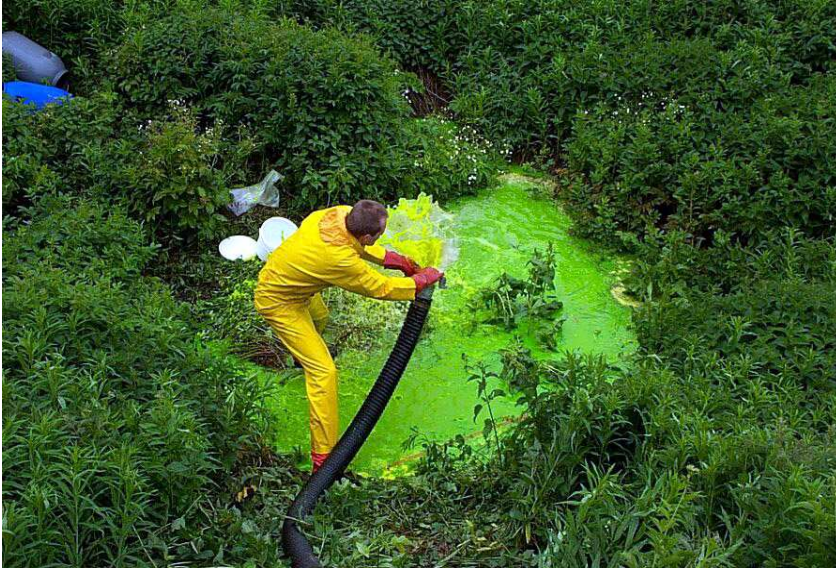
Injection de colorant dans une perte qui collecte les égouts du village des Moussières (Coll. EPK).
